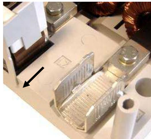
7 – Enfiler l'étrier sur l'extrémité du câble et faire glisser celui-ci le long du câble, dénudé sur 45 mm.
