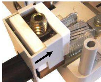
10 – Serrer légèrement la vis de l'étrier et vérifier la mise en place correcte du patin avant de serrer complètement la vis à l'aide d'une Clé mâle 6 pans de 6mm « Allen » (couple de serrage 45 N.m).
