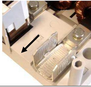
7 – Enfiler l'étrier sur l'extrémité du câble et faire glisser celui-ci le long du câble, dénudé sur 45 mm.
