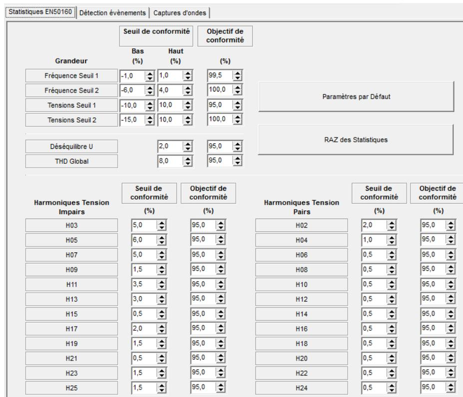
Figure 3-1 : Exemple d'affichage du sous onglet 'Statistiques EN50160'
