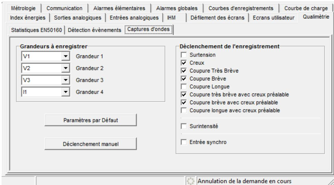
Figure 3-5 : Exemple d'un affichage du sous onglet 'Captures d'ondes'
