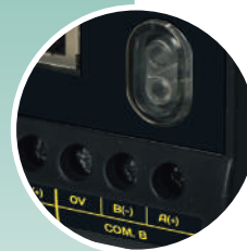
2 ports RS485 (Modbus/jbus RTU) mode maître
