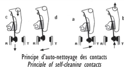
Principe d'auto-nettoyage des contacts
