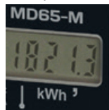
Visualización del índice de energía en la pantalla LCD
