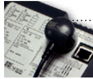
Comunicación local por cabeza óptica
