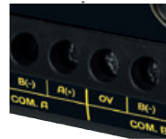
2 salidas RS485 (Modbus/Jbus RTU) Modo maestro
