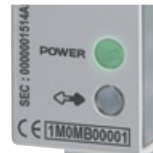
LED de estado de actividad de la comunicación
