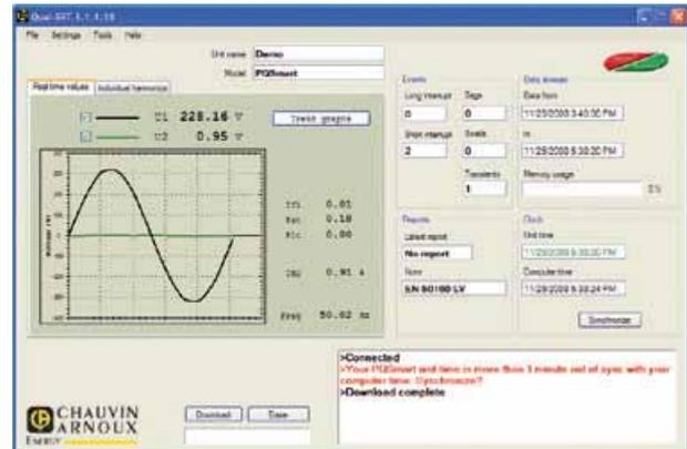
Qual-SRT : visualisation temps réel de la forme d'onde en connexion avec un MAP 607
