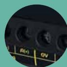
2 ports RS485 (Modbus/jbus RTU) mode maître
