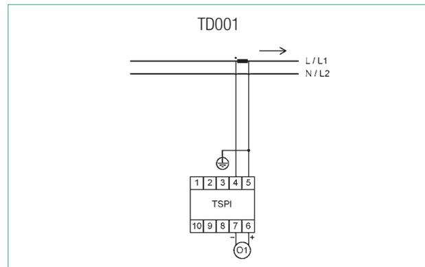
⚠ La borne 1 peut être raccordée indifféremment au neutre ou à l'une des phases du réseau électrique
