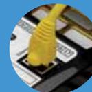
Une sortie Ethernet (Modbus TCP)
