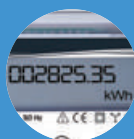
Affichage de l'index d'énergie sur écran LCD
