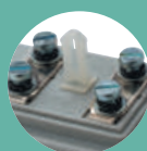
Sorties sur bornes dédoublées permettant de court-circuiter le secondaire sans risque (M4 ou cage pour fil 4 mm 2 )
