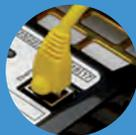
Une sortie Ethernet (Modbus/TCP)
