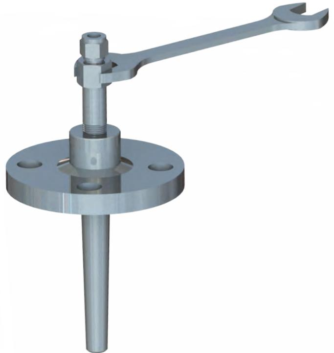
Visser l'extension basse sur les puits thermométriques à l'aide d'une clé plate de 27 en utilisant le 6 pans de la traversée étanche.
