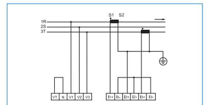
Exemple de raccordement sur TP
