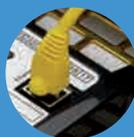
Une sortie Ethernet (Modbus TCP)
