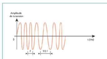
La valeur moyenne de la fréquence fondamentale doit être comprise dans l'intervalle  $50 \text{ Hz} \pm 1 \%$  dans des conditions normales d'exploitation.
