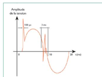
La mesure des surtensions transitoires nécessite des analyseurs numériques avec une fréquence d'échantillonnage élevée.
