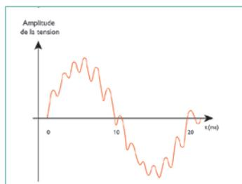
Harmonique : superposition sur l'onde fondamentale (50 Hz) d'ondes sinusoïdales de fréquences multiples de 50 Hz.
