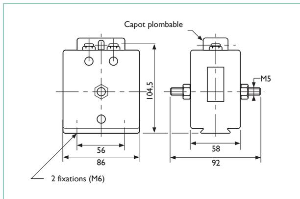
TC conçu pour additionner les valeurs instantanées du courant provenant du secondaire de 2 ou 3 transformateurs de courant. Il alimente ainsi les appareils de mesure ou de comptage, sur des installations comportant plusieurs départs ou arrivées.
