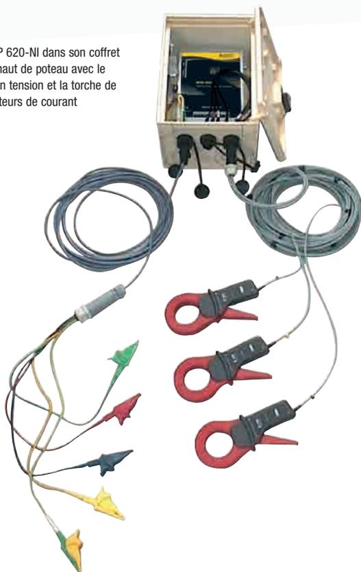
Sortie des connecteurs étanche sur la face inférieure du coffret
