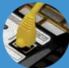
Une sortie Ethernet (Modbus/TCP)
