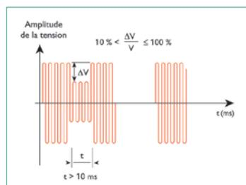
La plage de variation nominale de la tension réseau est fixée par le distributeur d'énergie à  $\pm 10\%$  de la tension composée.
